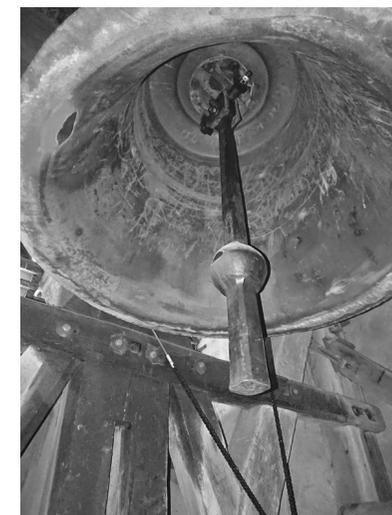
defekter Klöppel mit Halterung und bereits angeschlagene Glocke
